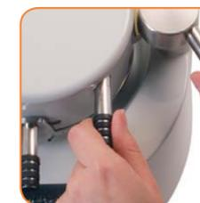
Une fois le temps de chauffe terminé, rabattre la chambre de pression sur le modèle et fermer le levier de verrouillage.
