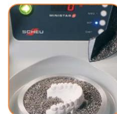
Poser le modèle sur la plateforme ou recouvrir son socle de granulés et mettre en place la plaque.
